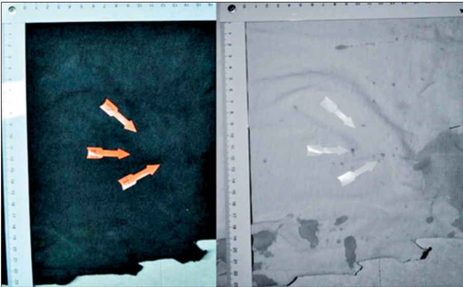
Abb. 1: Blutspritzer auf dunkler Oberbekleidung unter Tageslicht (links) und unter Infrarotbeleuchtung (rechts).
